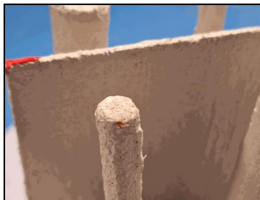
Fotografía nº4: «Punto de corrosión en barra de acero al finalizar el ciclo de condensación»
