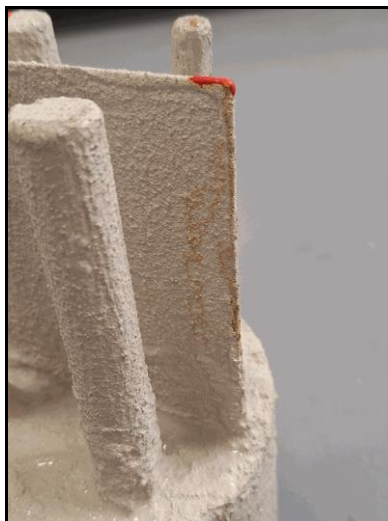
Fotografía nº9: «Corrosión férrica en borde de palca de acero al finalizar el ciclo de niebla salina»
