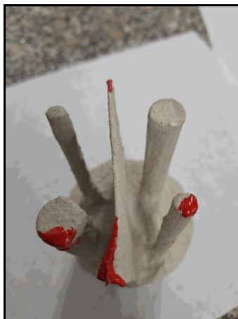
Fotografía n°2: «Muestra para ensayo con resina epoxi en zonas deterioradas»
