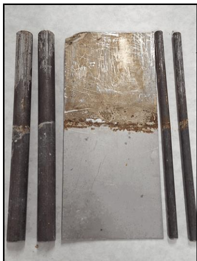
Fotografía nº14: «Barras y placas una vez eliminado todo el revestimiento»
