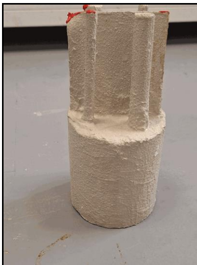
Fotografía nº7: «Muestra al finalizar el ciclo de niebla salina»
