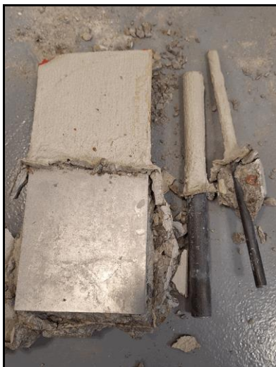
Fotografía nº10: «Placa de acero y barras tras romper hormigón»
